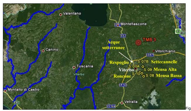
ura 4.7. Posizione dei punti di campionamento della rete di monitoraggio della qualità delle acque sotterranee in prossimità dell'impianto TMB di Viterbo.
